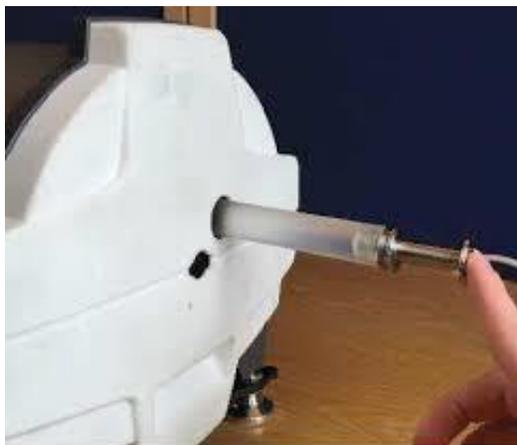
**Figura 3** Alloggio per la camera a ionizzazione
