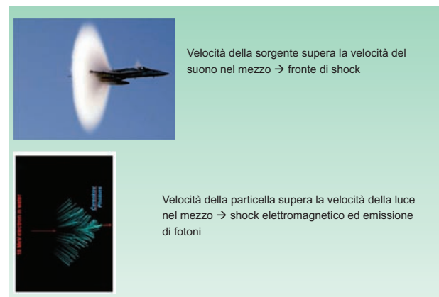
Figura 9: Immagine in alto: shock acustico generato da un aereo che viaggia a velocità supersonica. In basso: shock elettromagnetico generato da una particella che viaggia a velocità superiore a quella della luce nel mezzo.
