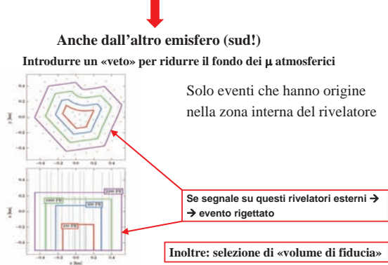
Figura 25: Schema del rivelatore ICECUBE, con indicazione del veto utilizzato per rigettare eventi con origine fuori dalla zona strumentata.
